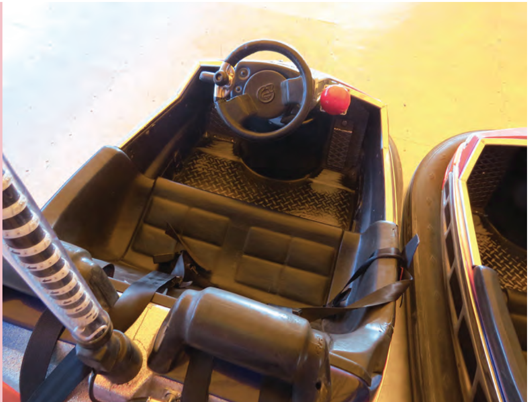
Oktoberfest – Installation von Handgas und Lenkradknopf in einem Autoscooter
